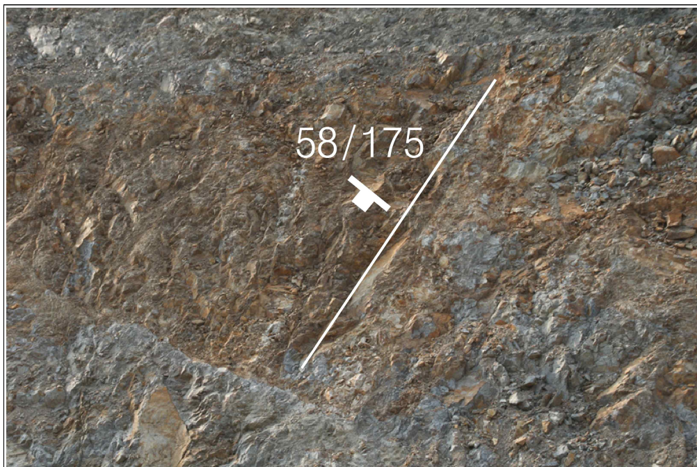
【그림 13】 A 영역에 발달한 불연속면
