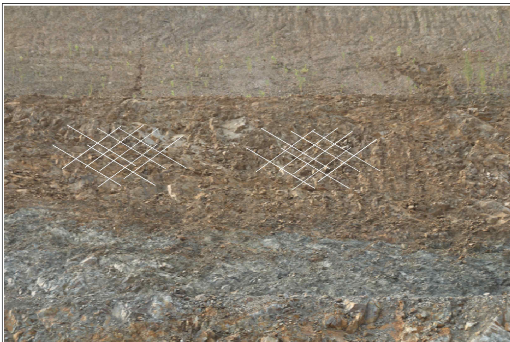
【그림 15】 A 영역 상세사진 (세편화된 암석)
